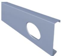
Cette ouverture d'une largeur de 120 mm et d'une longueur de 140 mm **convient au passage de toutes sortes** de tuyaux tels que des conduits de ventilation, des drains, etc. Cette option **n'est disponible que sur les profilés les plus larges** : C200 et C250.
