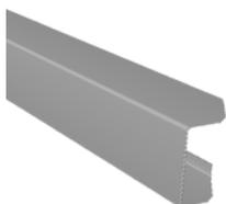
Cette opération est réalisée automatiquement lorsqu'un profilé n'est pas raccordé perpendiculairement à un autre, **afin qu'ils s'emboîtent plus facilement**.
